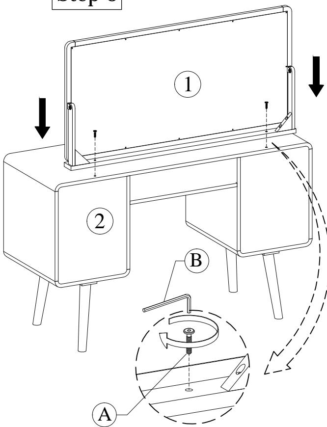
3. Pasang cermin pada bodi bagian atas sesuai lubang yang tersedia menggunakan baut Jcbc M6 x 30, putar kearah kanan searah jarum jam hingga baut terpasang rapat memakai kunci L.
